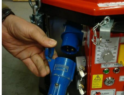
電源ケーブルを抜く
