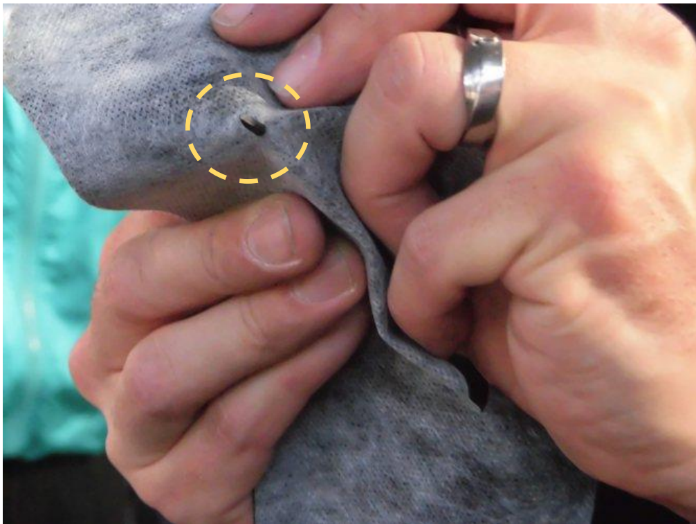
15. シートの裏にナイデックテープを貼り釘で穴を開けている様子。釘先端の黒い部分はナイデックの接着剤です。ナイデックの高い粘着力が釘穴を塞ぎ防水性を確保します。
