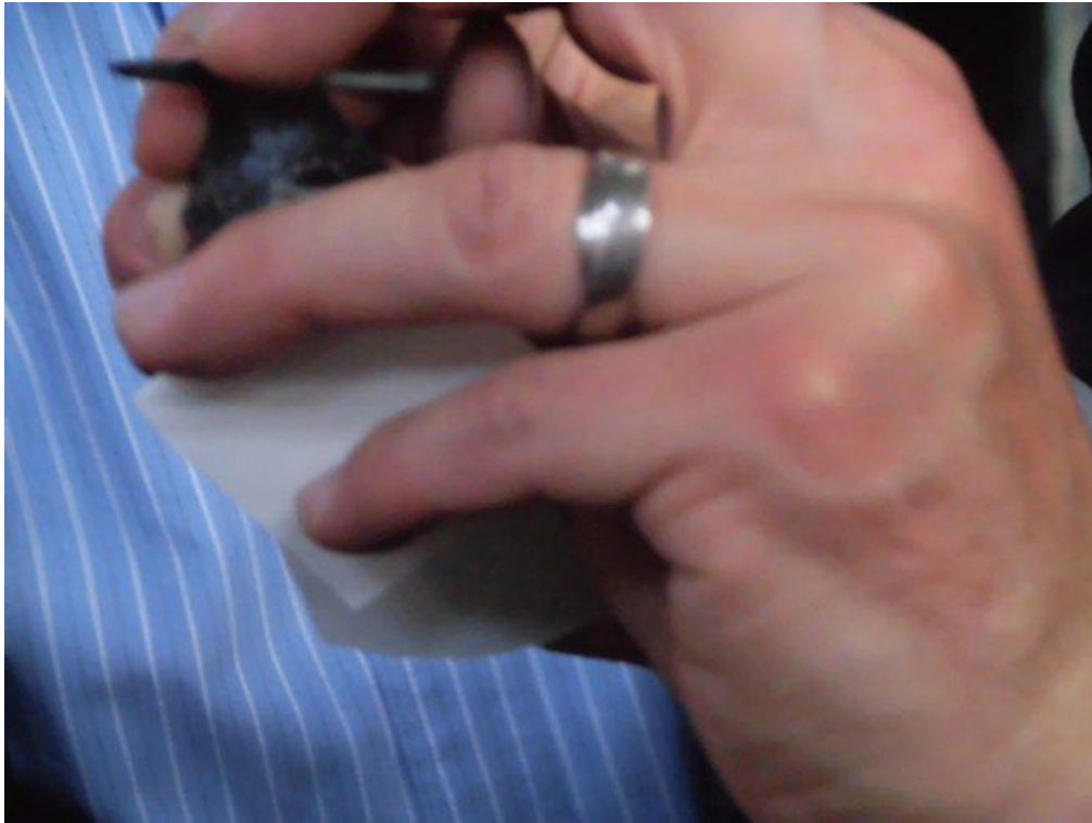
14. ナイデックテープに釘で穴を開けている様子。黒い色のナイデックの接着剤が非常によく伸びています。
